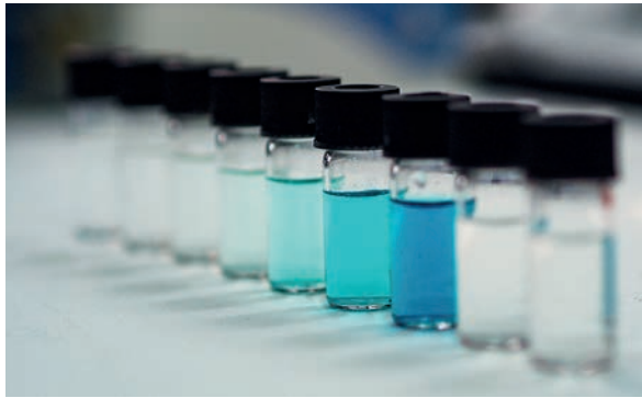
Farbstoffassays sind „altmodisch“ – richtig eingesetzt aber Gold wert: Mit diesem Test wird atomarer Sauerstoff in plasmabehandelten Flüssigkeiten nachgewiesen.
